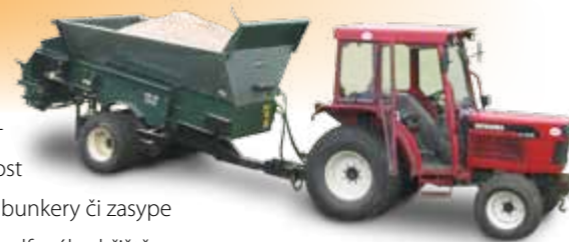
Wide Spin™ technologie umožňuje nastavení diskového rozmetacího ústrojí pod libovolným úhlem (0±15° u CR10 a 0±18° u CR7)
