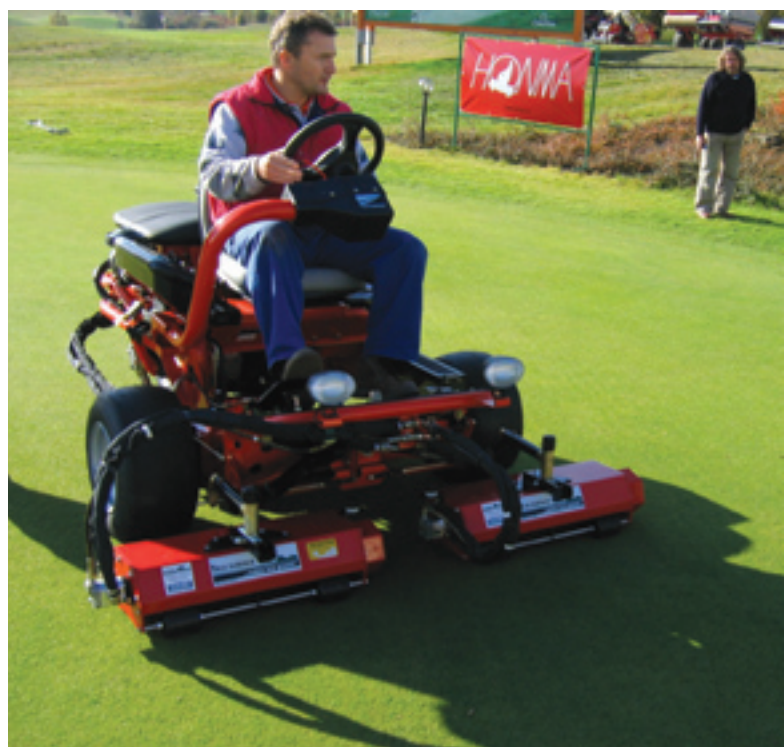
G-plex s vibračními válci Tru-Surface Select-A-Vibe – vynikající nástroj pro zrychlení greenů, zapravení písku či jiného materiálu do drážek a jamek pro aerifikaci a vertikutaci, zhutnění nově zasetých greenů nebo uválení povrchu po dosevech (nastavitelná hladina vibrací na 5ti hladinách)
