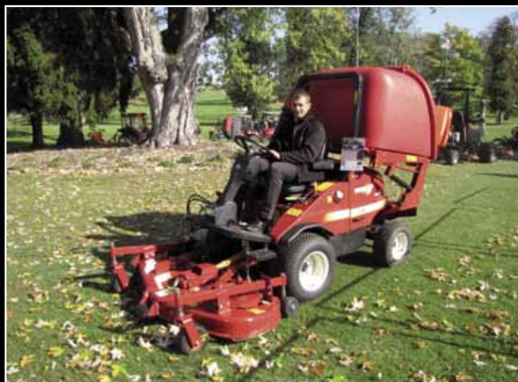
Sběr listů pomocí rotační sekačky Shibaura CM374 se sběracím košem s výklopem do výšky
