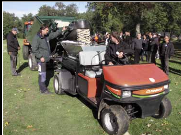
Ukázka diskových pískovačů Turfco - WS1540 nábavba na Cushman plněný za pomoci multifunkční CR10
