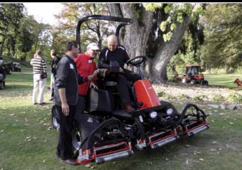
Model LF550 má greenová vřetena o průměru 12,5 cm.
