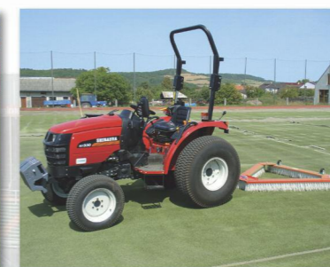
Lehký japonský malotraktor Shibaura s kartáčem Verti-Broom na umělé povrchy.
