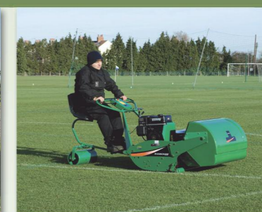
Jednovřetenová sekačka Mastiff s pojezdem pro údržbu fotbalových hřišť.
