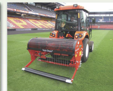
Verti-Drain – aerifikátor fotbalových hřišť a sportovních travnatých ploch s plnými nebo dutými hroty.
