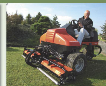
Novinka – vertikutační vřetena pro TK 1900 s pracovním záběrem 180 cm.
