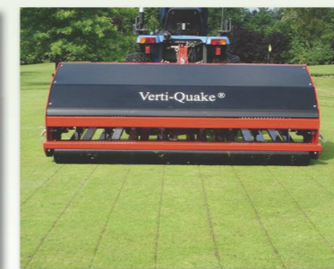
Verti-Quake provzdūšňuje ztuhlou půdu břitý šavlovitých nožů.
